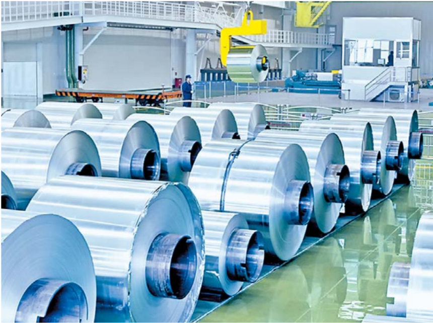
شىنجاڭ جۇڭخۇا ئېلېكترون ئالىيىم ياپراقچە شىركىتىنىڭ ئېلېكترون ئالىيىم ياپراقچە ئىشلەپچىقىرىش لىنىيەسى (12 - ئاينىڭ 19 - كۈنى تارتىلغان). شىنجاڭ جۇڭخۇا پاي چەكلىك شىركىتى بىلەن 35 مىڭ توننا ئېلېكترون ئالىيىم ياپراقچە ئىشلەپچىقىرىدۇ، رەقەملىك سۈرەت تارتىش، سىناپ ئېلىش ئۈسكۈنىلىرى، كۆچمە خەۋەرلىشىش ئۈسكۈنىلىرى، كومپيۇتېر ئۈسكۈنىلىرى قاتارلىقلاردا كەڭ ئىشلىتىلىدۇ.
